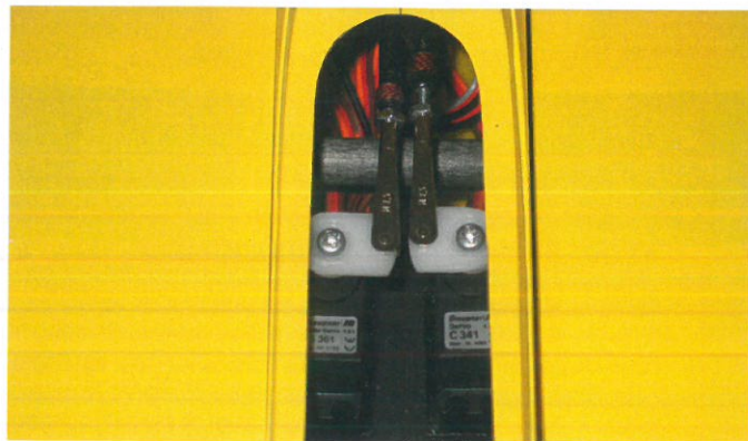
Des palonniers surdimensionnés et des commandes en tube carbone bien guidées participent à la précision en vol.
