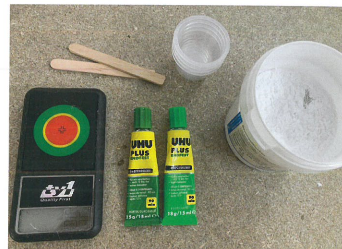
Le matériel nécessaire pour le collage à l'époxy : godet, bâton touilleur, flocc de coton et idéalement une balance de précision pour bien doser la colle et le durcisseur.
