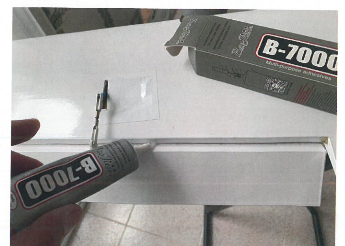
La colle B7000 reste souple et permet de réparer les articulations faites au scotch. Le séchage prend 72 heures.
