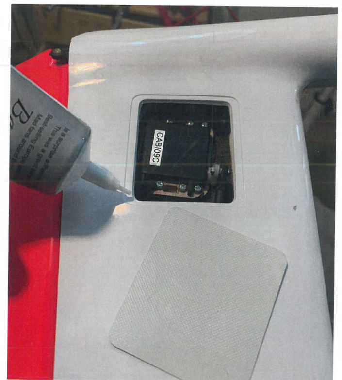
Les trappes de servos collées à la B7000 restent démontables
