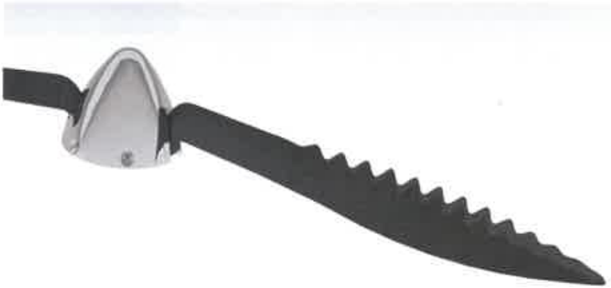
Voici une hélice peu commune. Il s'agit d'une hélice de vitesse 10X22 (oui oui...) prévue pour être réduite (5/1). Les dents sur le bord d'attaque des pales facilitent la pénétration dans l'air, à l'image des nageoires des baleines à bosses. Certaines entreprises travaillent sur ce concept pour équiper les futures eolennes...
