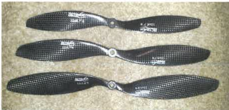
Les hélices en carbone sont de plus en plus utilisées. Bien qu'elles soient plus chères et assez fragiles, elles présentent des rendements largement supérieurs grâce à leur légèreté et à leur rigidité (moins de déformation).
