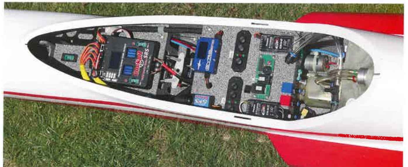
Une installation radio rigoureuse est un gage de fiabilité : éléments bien immobilisés, fils parfaitement protégés etc... C'est finalement assez facile à faire, il suffit d'un peu de bon sens et d'ordre !
