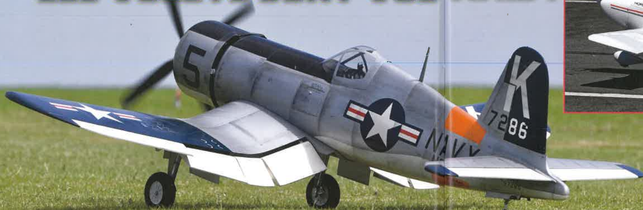
S'il est bien un type d'avion pour lequel il est impératif de poser court, ce sont bien les chasseurs embarqués sur les porte-avions, ce qui explique la taille et le débattement des volets sur le F4U Corsair...
