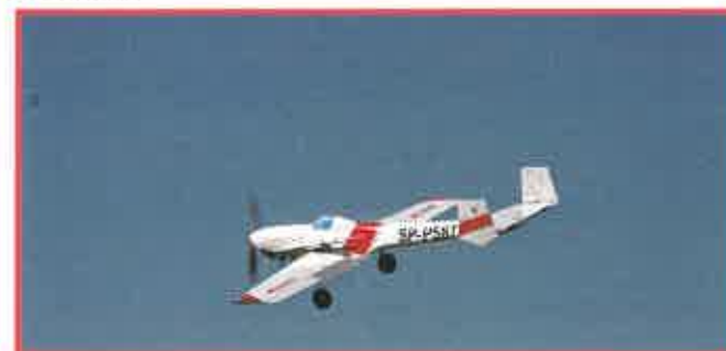
Les remorqueurs cherchent à gagner du temps sur les retours, les volets permettent de freiner tard et d'atterrir court, donc souvent de ne pas avoir à revenir vers le seuil de piste.
