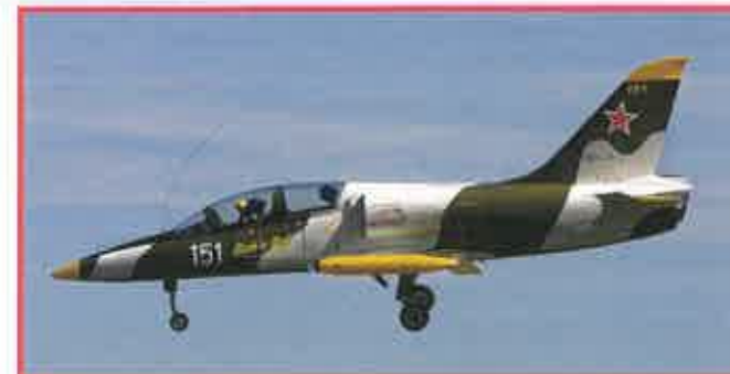
Si rapide en lisse, le L-39 se pose très sagement avec ses volets à fente efficaces.
