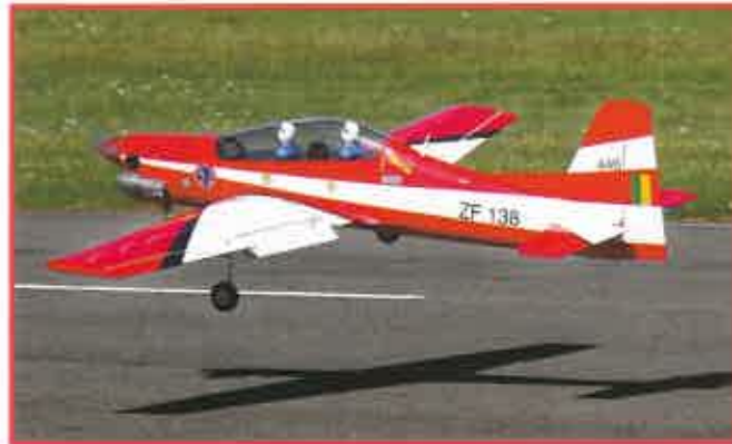
Les volets au premier cran permettent un décollage en souplesse et avec une réduction de la longueur de roulage nécessaire.
