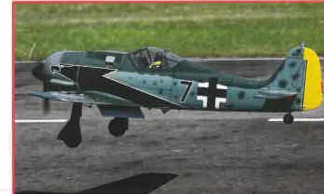
Grâce à la traînée des volets, le modèle ralenti plus vite lors de l'arrondi et flotte moins longtemps en effet de sol.
