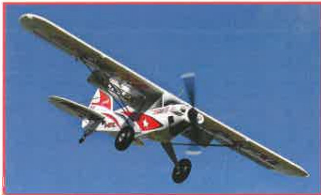
Sur le Fun Cub XL, la compensation profondeur quand les volets sont braqués à 80° atteint 14 mm à piquer.
