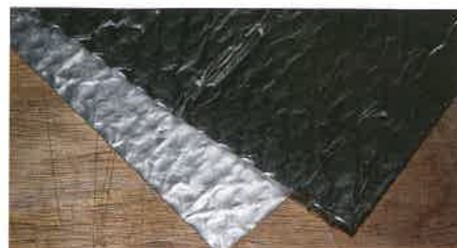
Le plastique-bulle utilisé comporte deux faces différentes. Le côté alu se place à l'extérieur pour protéger des UV et de la chaleur, tandis que le côté transparent thermosoudable permet l'assemblage.
