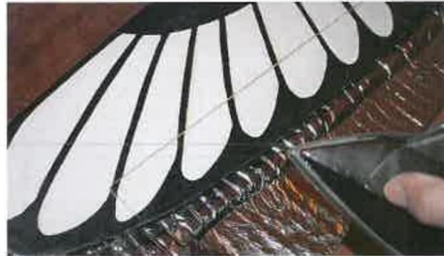
Les deux épaisseurs de film sont plaquées par le fer chaud. La face extérieure brillante ne bouge pas tandis qu'à l'intérieur le plastique fond, assurant la jonction solide. On laisse une marge de quelques centimètres tout autour pour que l'aile puisse glisser librement dans sa housse.
